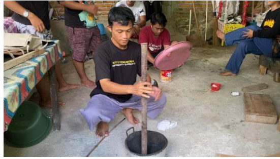
Gambar 3. Penumbukan limbah Batok Kelapa menjadi halus
