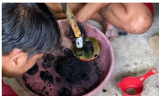
Gambar 4. Pencetakan bubuk arang limbah Kelapa yang sudah dicampur dengan tepung kanji menjadi Briket
