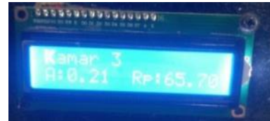
Gambar 4.6 lcd sensor 3 tanpa beban
