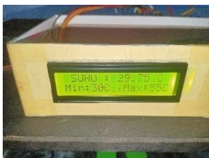
Gambar 5 Tampilan Hasil Pengujian Rangkaian Sensor Suhu dan LCD
