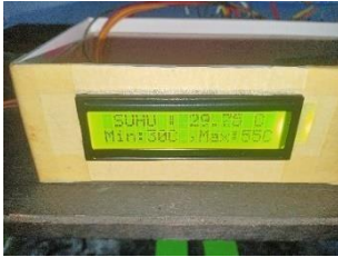
Gambar 5 Tampilan Hasil Pengujian Rangkaian Sensor Suhu dan LCD
