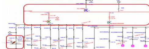
Gambar 5 Pengujian sistem proteksi PT HGI pada bus beban motor
