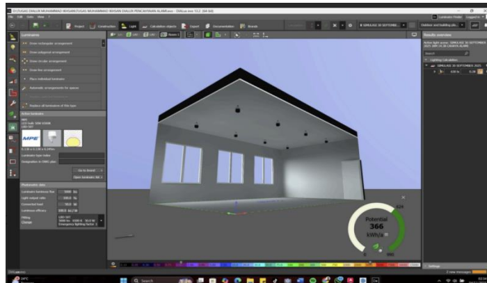
Gambar. 1. Permodelan pada Simulasi Pencahayaan Alami Tanpa Pohon
