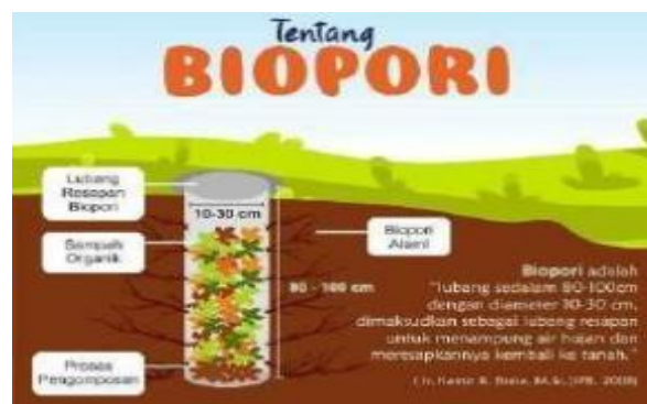
Gambar 4. Pemanfaatan biopori sebagai sistem resapan air dan pengomposan di Desa Sukunan
